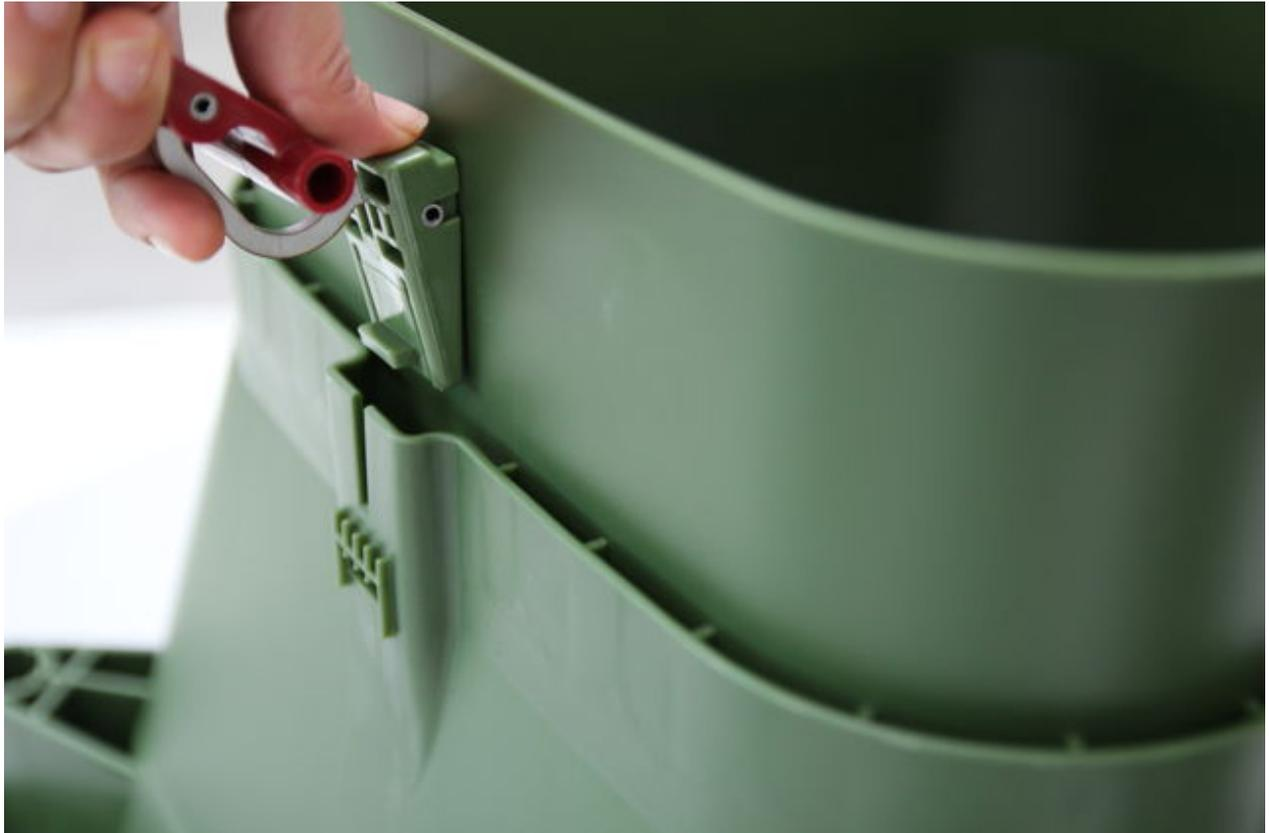
Legen Sie das Unterteil so auf den Boden, dass die untere Öffnung nach oben weist. Schieben Sie je einen Spannverschluss in je eine der Aussparungen an jeder Seite des Unterteils. Dieses braucht etwas Kraft. Sie können einen Schraubendreher benutzen um die Spannverschlüsse nach unten zu drücken oder vorsichtig mit leichten Hammerschlägen nachhelfen. Die Spannverschlüsse müssen hörbar in den Aussparungen einrasten.
