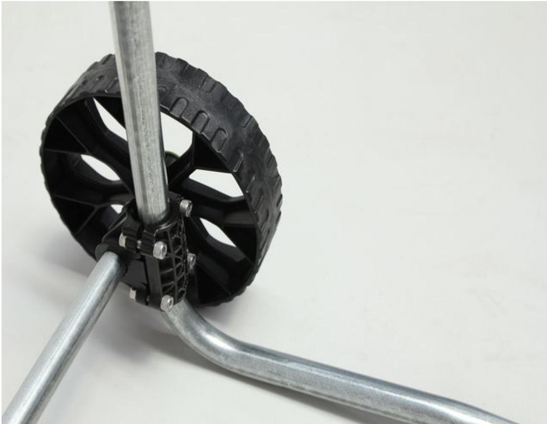
Vergewissern Sie sich, dass die Räder den Boden berühren wenn der Rahmen aufrecht steht. Schieben Sie die Achsklemmen auf der Achse bis ganz nach außen zu den Rädern. Ziehen Sie mit Hilfe des beigefügten Sechskantschlüssels die 4 Schrauben gleichmäßig an, bis die Achsklemmen die Achse sicher am Rahmen fixieren. Achten Sie beim Anziehen der Schrauben darauf, dass die Abstände auf beiden Seiten der Achsklemme gleich weit sind.
